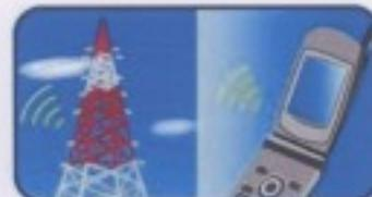
接近會產生相同無線電訊號波段的裝置（例如使用 1.5GHz 波段的行動電話），或是在會產生磁場的場所（接近高壓電塔）。
