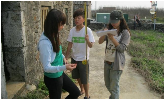
【圖 42】測繪七美傳統住屋，以了解其尺度與配置。測繪以三人一組，兩人測量，一人記錄繪圖資料與拍照。
