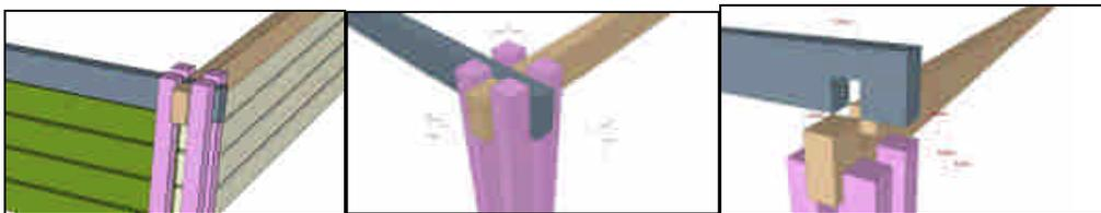
圖 30 框架接合示意圖
