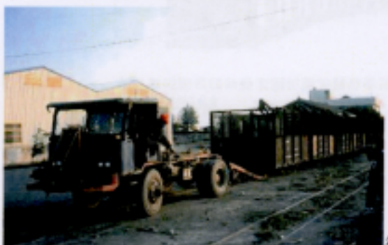
圖 15 可載運糖鐵甘蔗車廂的拼裝車及其卸載過程
