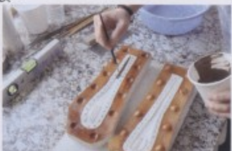
圖六十四： 塗刷混了色粉後的環氧樹脂液。
