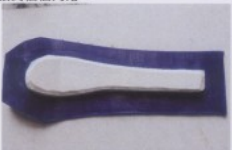
圖四十七：乾燥後的矽橡膠液形成矽橡膠模。
