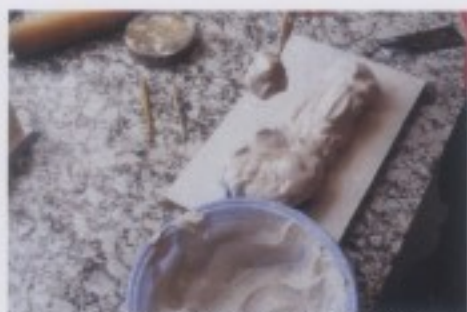
圖四十九：石膏漿泥倒在矽橡膠模上。
