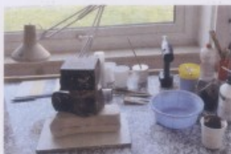
圖六十七：用重物擠押出多餘的環氧樹脂液。
