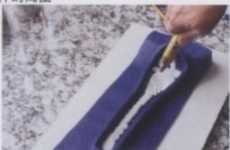
圖四十五：使用空氣噴槍使矽橡膠液流竄到個個角落。
