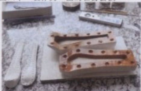
圖六十二： 剝開後的矽橡膠模與石膏套模。
