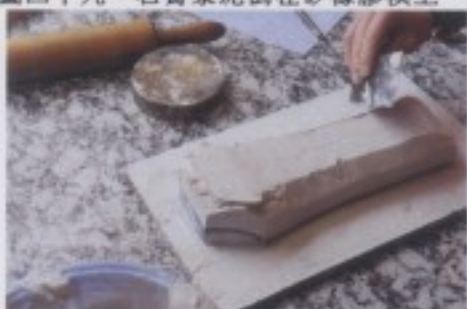
圖五十一：整平石膏漿泥並等待乾燥成石膏套模。
