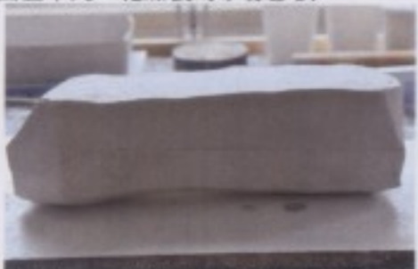
圖六十一： 乾燥後完整的石膏套模。
