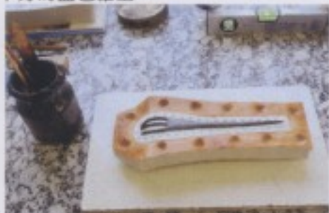
圖五十四：完整塗刷蟲膠與鑽孔後。
