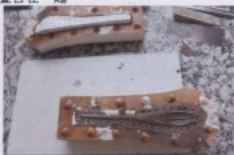
圖六十八：從兩塊石膏套模的分界線中間撬開。
