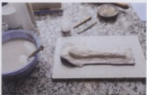
圖四十八：準備石膏漿泥製作石膏套模。
