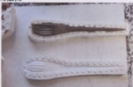
圖七十：已翻模的物件黏附在矽橡膠模。
