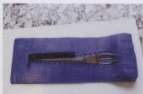
圖四十二：使用藍色黏土圍繞在要翻模的物件邊緣。
