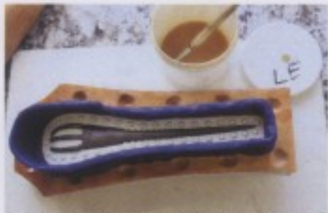
圖五十六：塗刷棕色色粉水溶液於矽橡膠模上。
