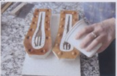
圖六十三： 塗刷上三層蟲膠於石膏套模。
