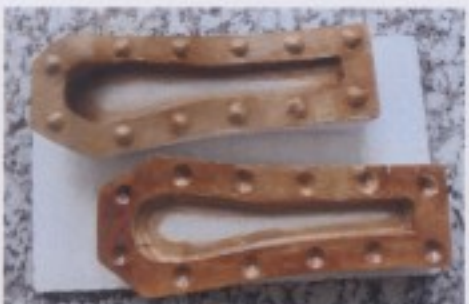
圖六十三： 塗刷上三層蟲膠於石膏套模。
