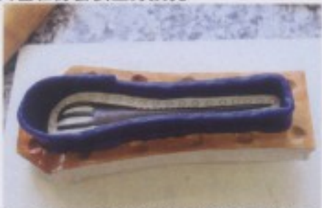
圖五十五：再次使用藍色黏土圍繞在要翻模的物件周圍。
