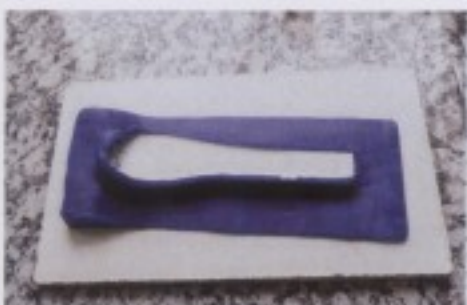
圖四十六：矽橡膠液均勻地倒入。
