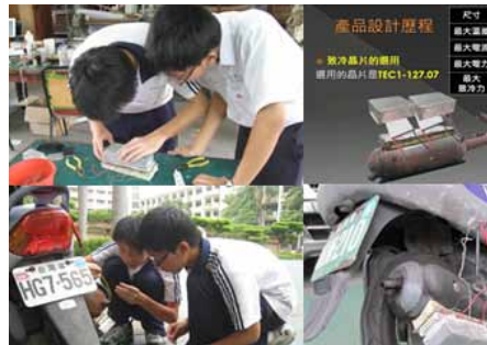
圖 4 排氣管廢熱回收 運用致冷晶片設計不需外加電源的散熱裝置
