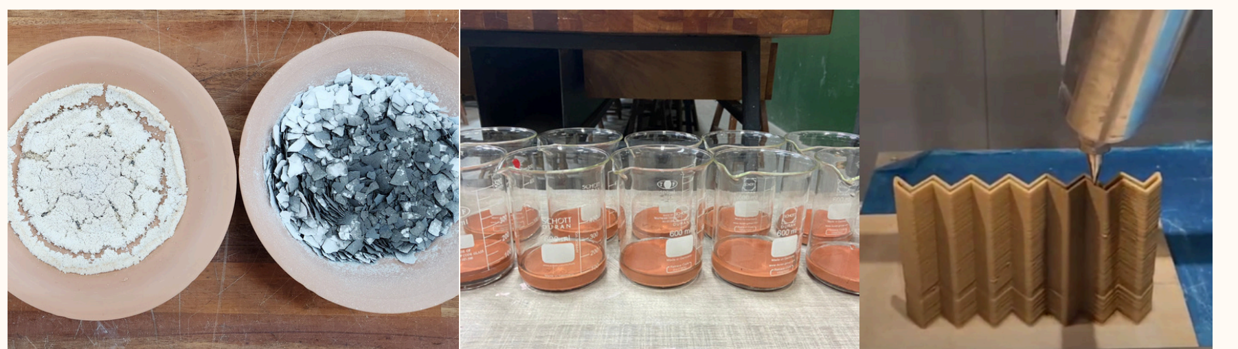
▲ 香灰磚瓦實驗:真空練土機混和原料、線鉅切割板材、3D列印機、硬度/耐久檢測
