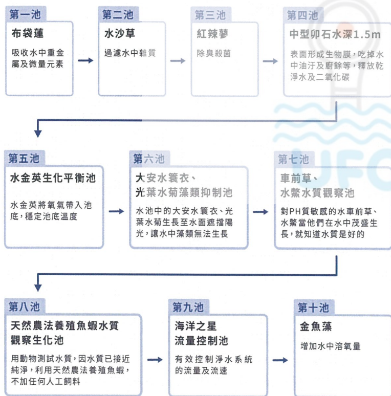
圖4.1.5: 【淨水2.0】十個淨化功能池運作流程
