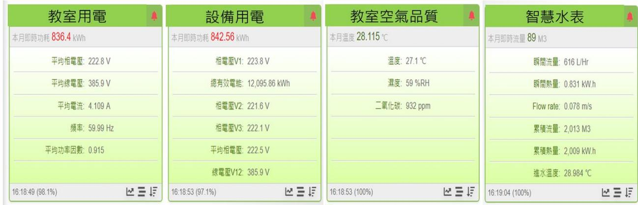
圖 1-16 能源管理系統(EMS)即時數據展示方式示意圖
