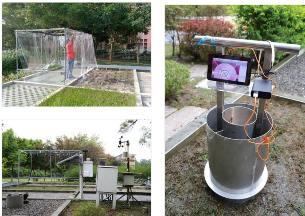
圖 31 透水鋪面試驗場
