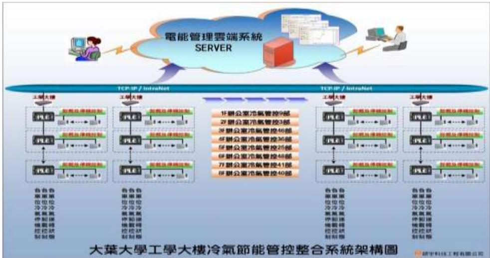
圖 27.小型冷氣機監控系統架構圖
