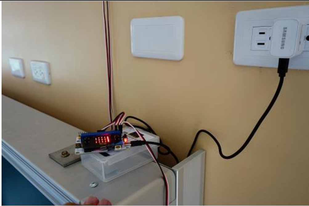
MICRO BIT 主機板及 AIOT 擴充版連接溫濕度及風速感應器
