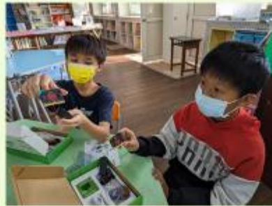
Micro bit裝上電池按下A鈕會亮起愛心圖案，代表正在記錄亮度
