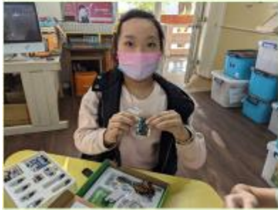
Micro bit裝上電池按下A鈕會亮起愛心圖案，代表正在記錄亮度
