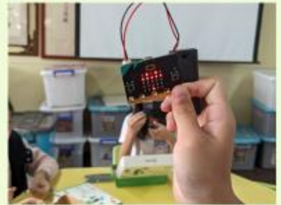
Micro bit裝上電池按下A鈕會亮起愛心圖案，代表正在記錄亮度
