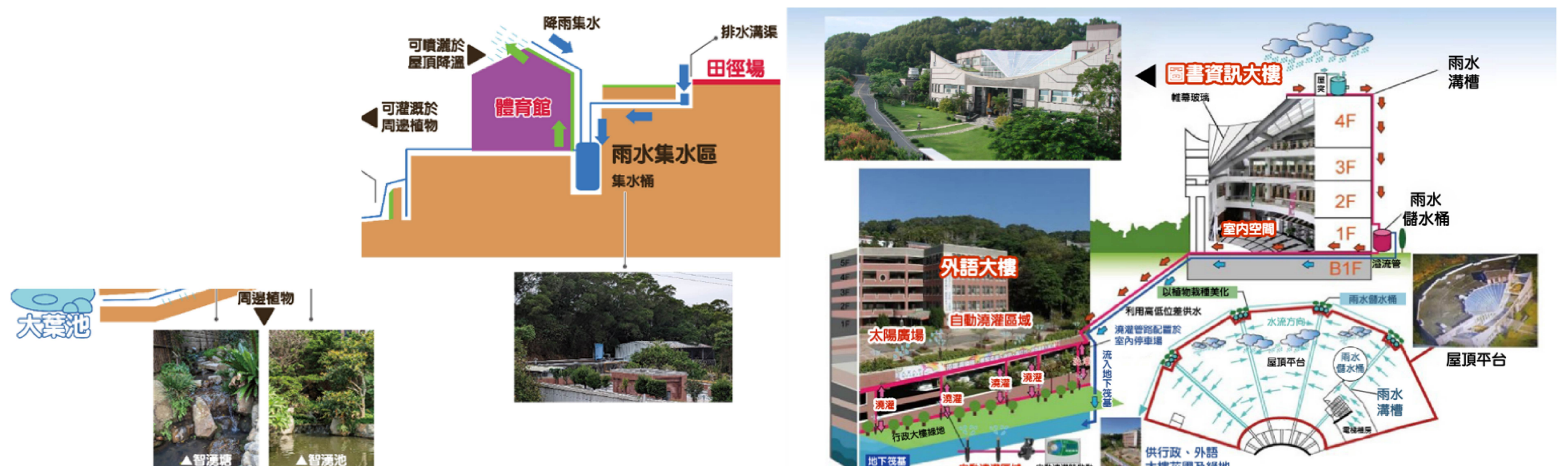
體育館雨水回收，利用地勢15公尺落差，可直接供應體育館周邊及工學大樓綠地，作為花木澆灌水源。儲存量72噸，每年雨水收集量800噸 圖書館收集雨水，利用地勢30公尺落差自然重力給水方式，供應至低處之外語與管理大樓景觀澆灌
