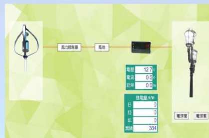
智慧風力發電裝置原理，風速 3m/sec 開始啟動風扇發電。
