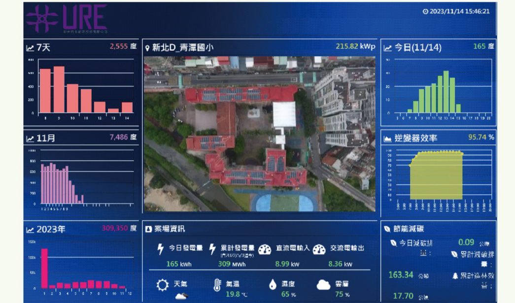
(本校太陽能光電板總建置容量為215.82KWp, 111年總發電量為127,567KWh。)
