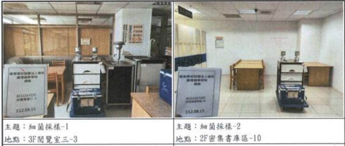
圖 10 室內空氣品質定期現場檢測
