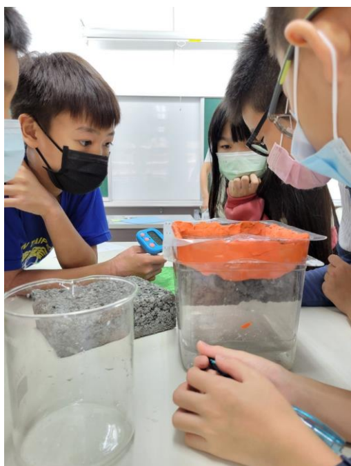
圖 6：計時透水磚表面沒有積水時的時間 長度
