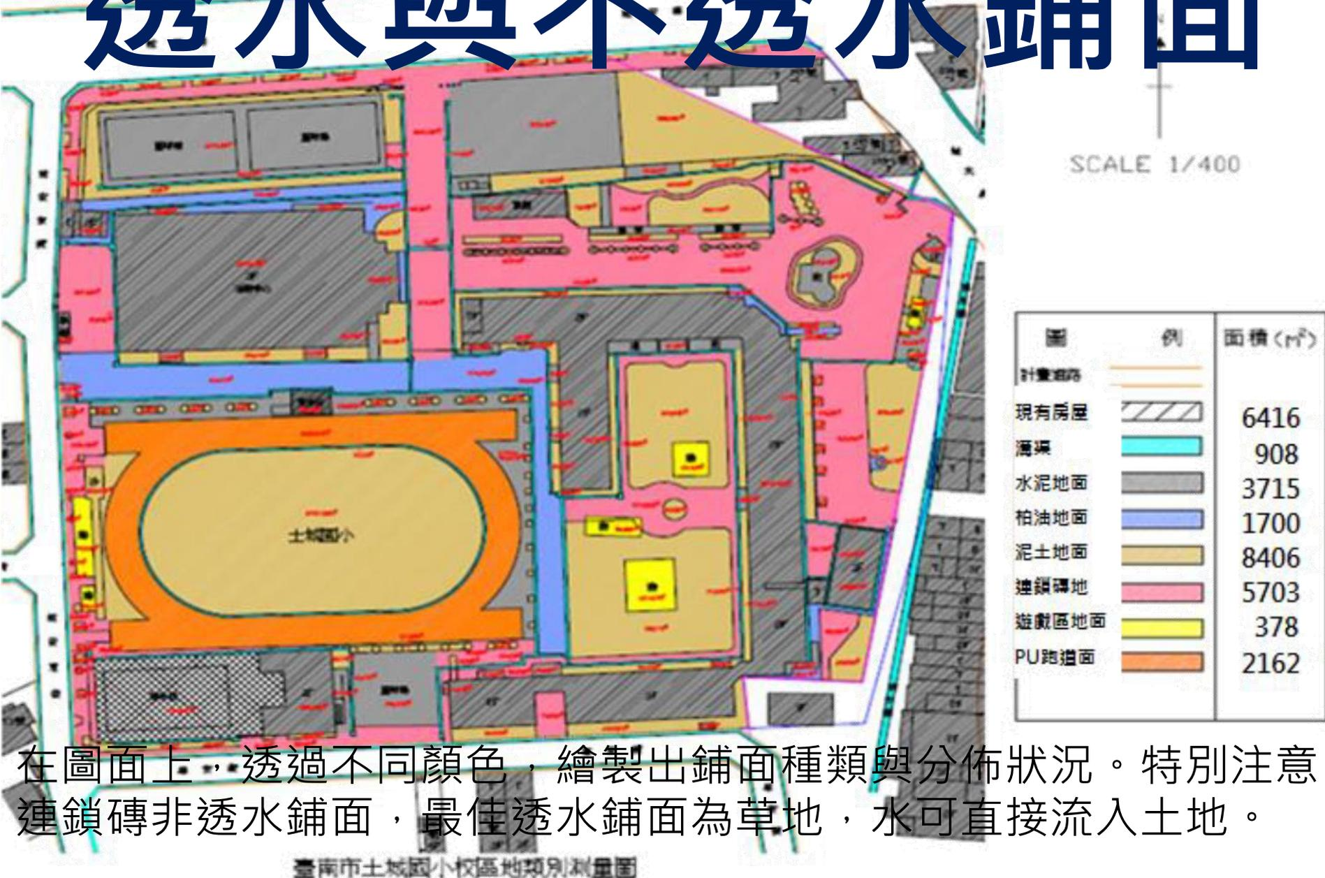
在圖面上，透過不同顏色，繪製出鋪面種類與分佈狀況。特別注意，連鎖磚非透水鋪面，最佳透水鋪面為草地，水可直接流入土地。
