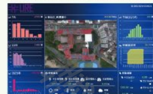
(本校太陽能光電板總建置容量為215.82Kwp、111年總發電量為127,567Kwh。)
